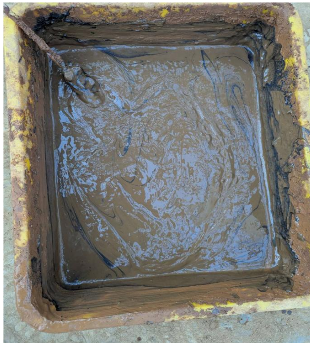
圖 15 生物炭與土壤及水混合
