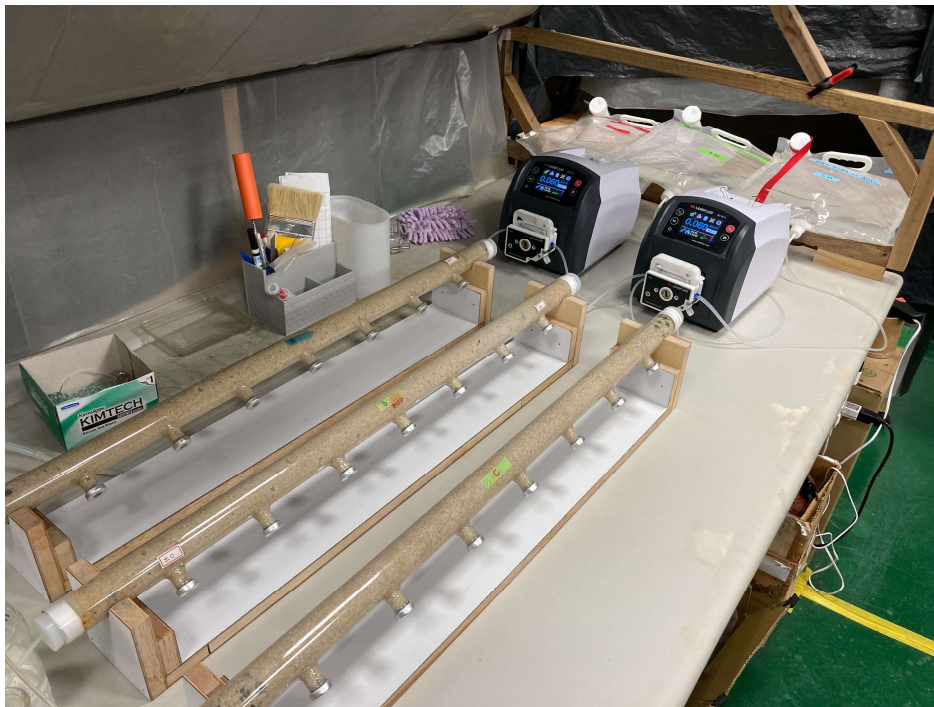
圖 4.4、管柱系統實體架設圖
