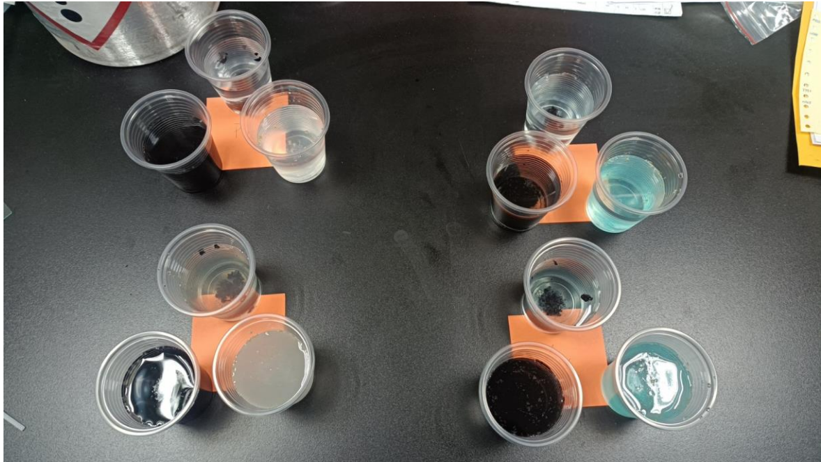
圖五十、生物炭、殼聚糖水凝膠及生物炭水凝膠複合材料吸附重金屬溶液（鉛、銅、鉻及混合溶液）
