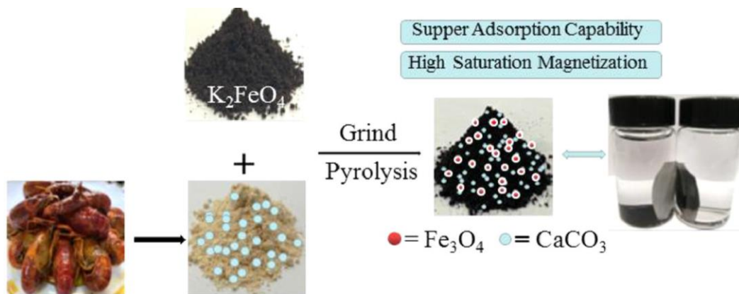
圖九、小龍蝦殼廢棄物製作生物炭流程
