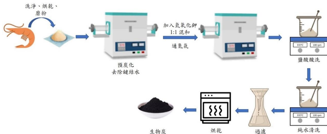
圖三十四、本計畫研究從蝦殼燒製生物炭流程圖
