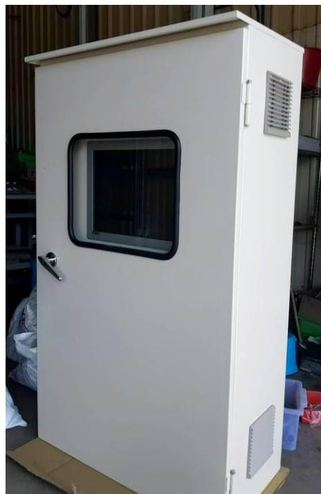
圖 十、活性碳吸附與再生電控裝置外觀
