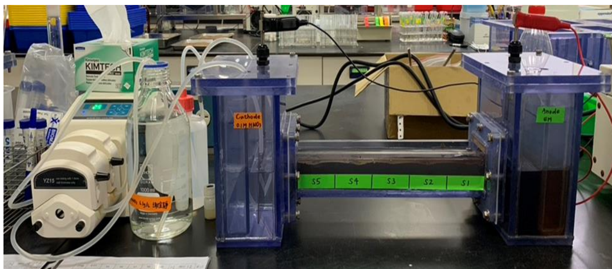
圖 4.5、第二階段實驗水平電動力法反應槽
