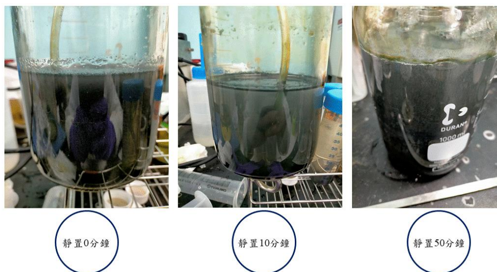
圖 5：製備完 SnZVI 於不同靜置時間之氧化程度比較，0 分鐘和 10 分鐘皆有磁鐵置於下方進行固液分離。
