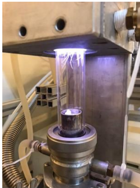
圖 10 載氣為氬氣之電漿火炬
