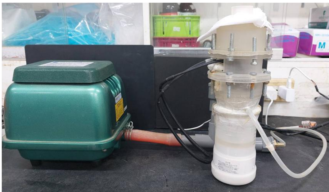
圖4-10 流體化床實驗架設(反應器可更換)(a)實驗架設示意圖 (b)實驗架設實體
