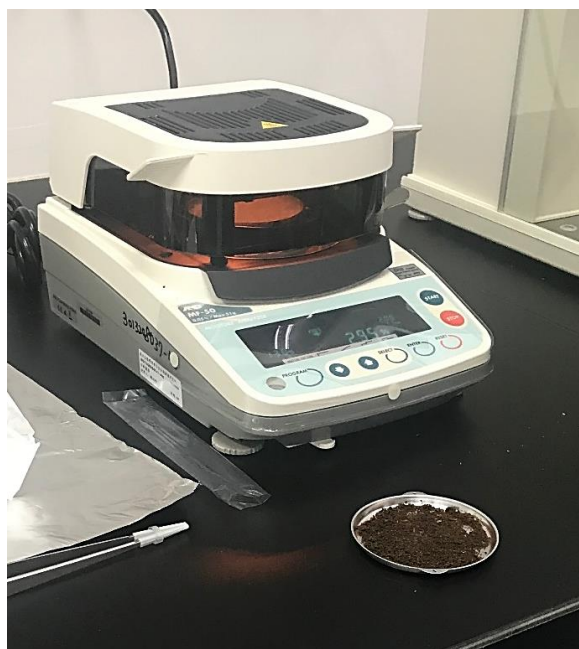
圖七、含水率測量
