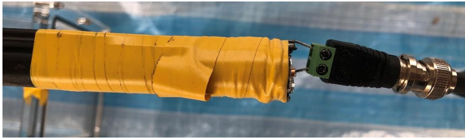
圖 4.29 附有吊線之 P3-500 纜線接頭處焊接鐵絲
