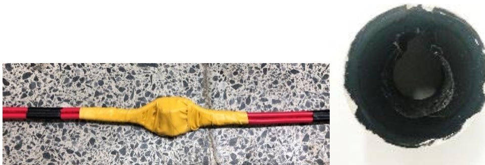
圖 3.10 記號(左:AWG16-2P;右:附有吊線之 P3-500)
