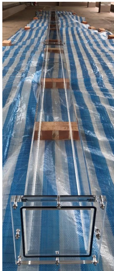
圖 3.4 模擬現地之壓克力實驗槽
