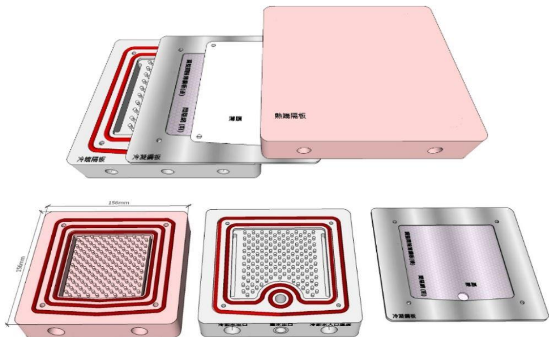
圖4.2 AGMD 模組組立圖(上圖)、AGMD 板框模組(下圖)
