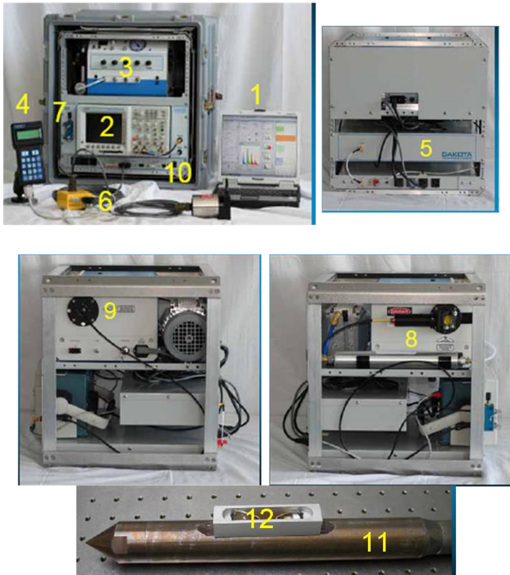
圖 4.1 本研究使用之 UVOST 雷射激發螢光系統
