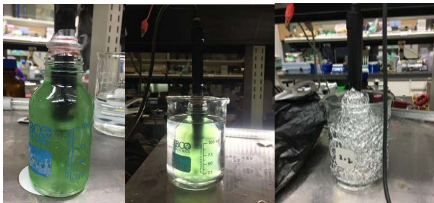
圖 23 產氧速率實驗裝置圖(照光期(中)、黑暗期(右))
