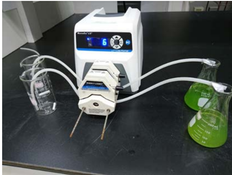
圖 16 微藻固定化設備
