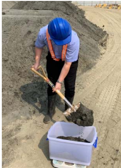
圖 5-1 高 TPH 油污染土壤採樣過程
