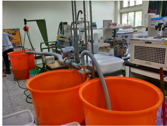
圖 4-3 水力漩流分離器之結構與實驗室組裝照(自有設備)
