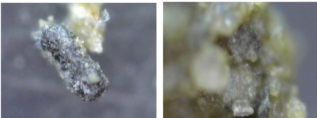
圖 5-8 高 TPH 油污染土壤經 30 分鐘反應後照片(非結晶型二氧化矽:油污染土壤=1:200，以 35 mg/l 高氧水當試劑水，水洗固液比設計為 1:2)
