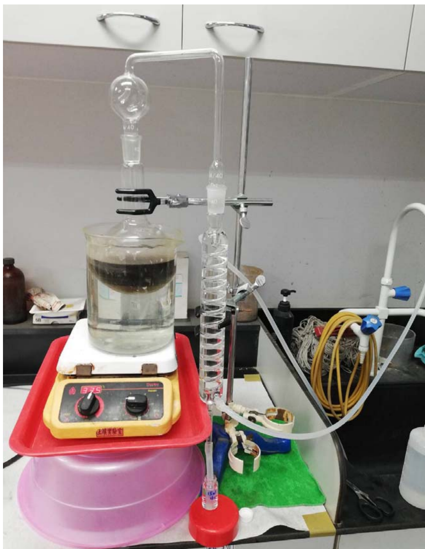
圖 6.15 反應牆污泥 BTEX 和 MTBE 溶出蒸餾置
