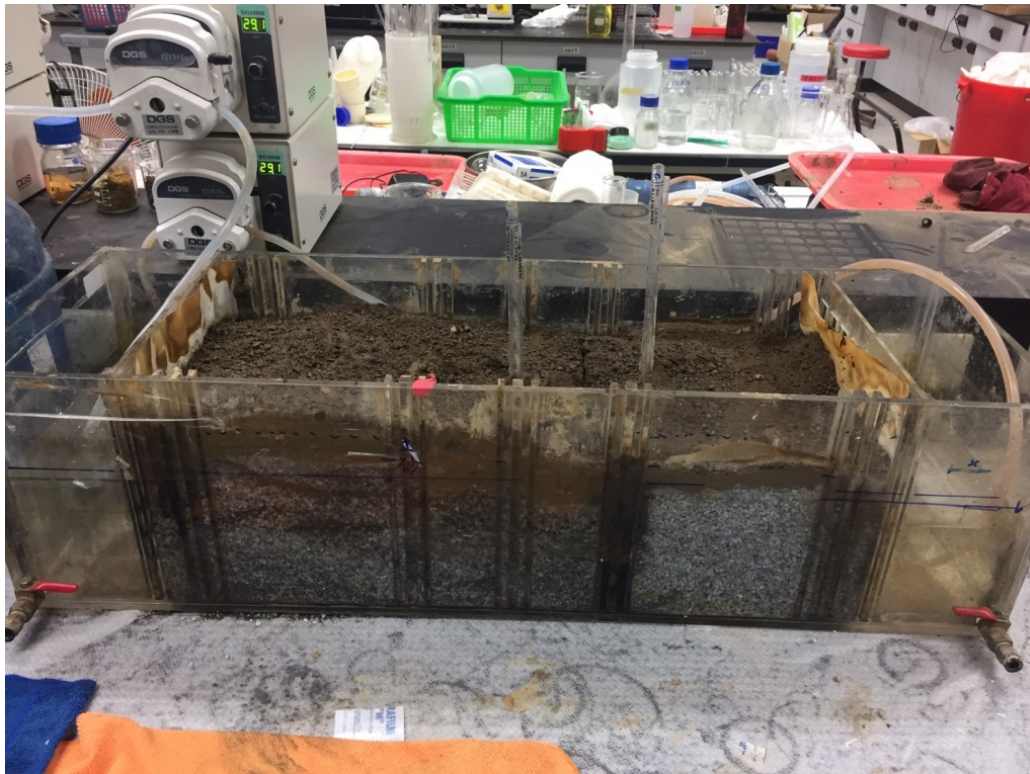
圖 4.3 小模組之吸附反應牆試驗配置
