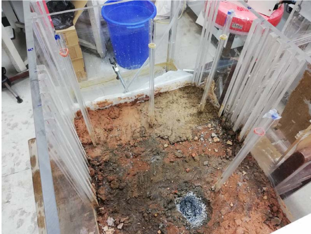
圖 6.9 採樣管之埋設 (三束並列者為牆後採樣點，單束為牆前污染區監控採樣點，二者間便是反應牆埋設區)
