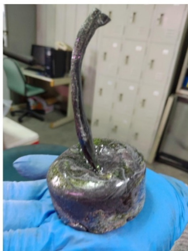
圖 5-2 現地真實污染土壤玻璃化成品(a)及切開後之內部情況(b)
