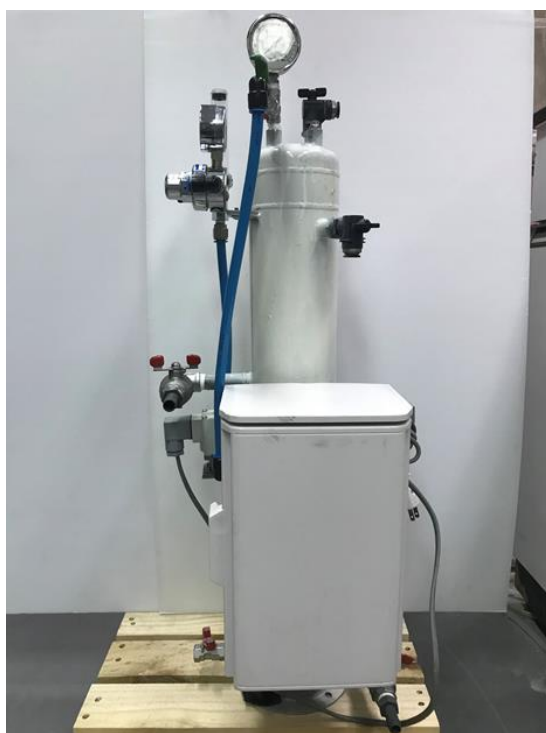
圖 3-7 高濃度氣體溶解裝置
