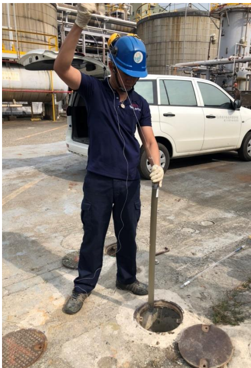
圖 4-26 地下水採樣
