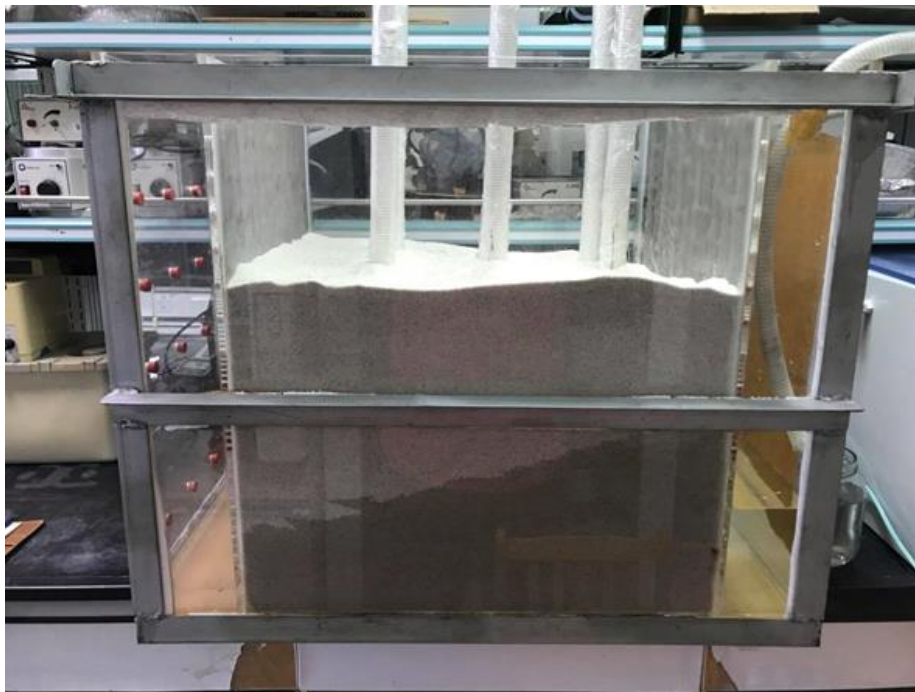
圖 3-3 砂箱試驗裝置圖
