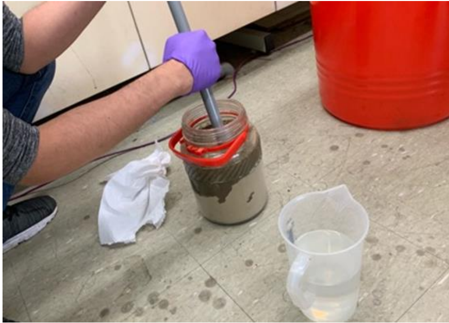
圖 5-7 為配製重金屬溶液並與 TY03 底泥混合均勻之過程
