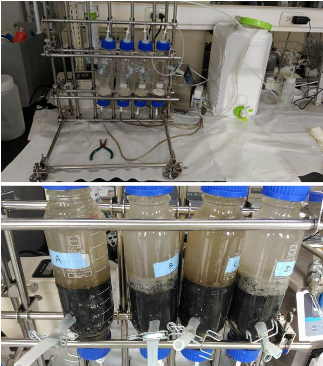
圖 3-11 上流式微型系統圖示
