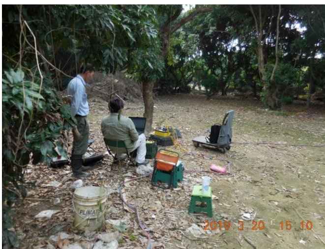
圖 4.3-4 現地多硫化鈣灌注及跨孔式地電阻監測情形
