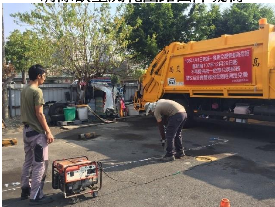
圖 31 地電阻量測： 清除欲量測範圍路面障礙物
