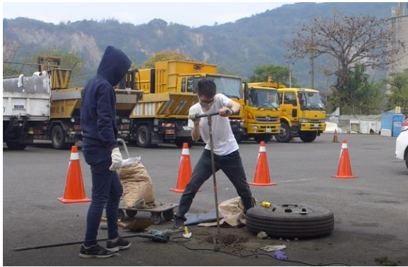
圖 39 土壤鑽探作業(手動採樣器)
