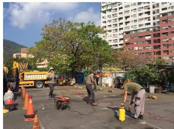
圖 33 地電阻量測： 澆水(增加導電率)
