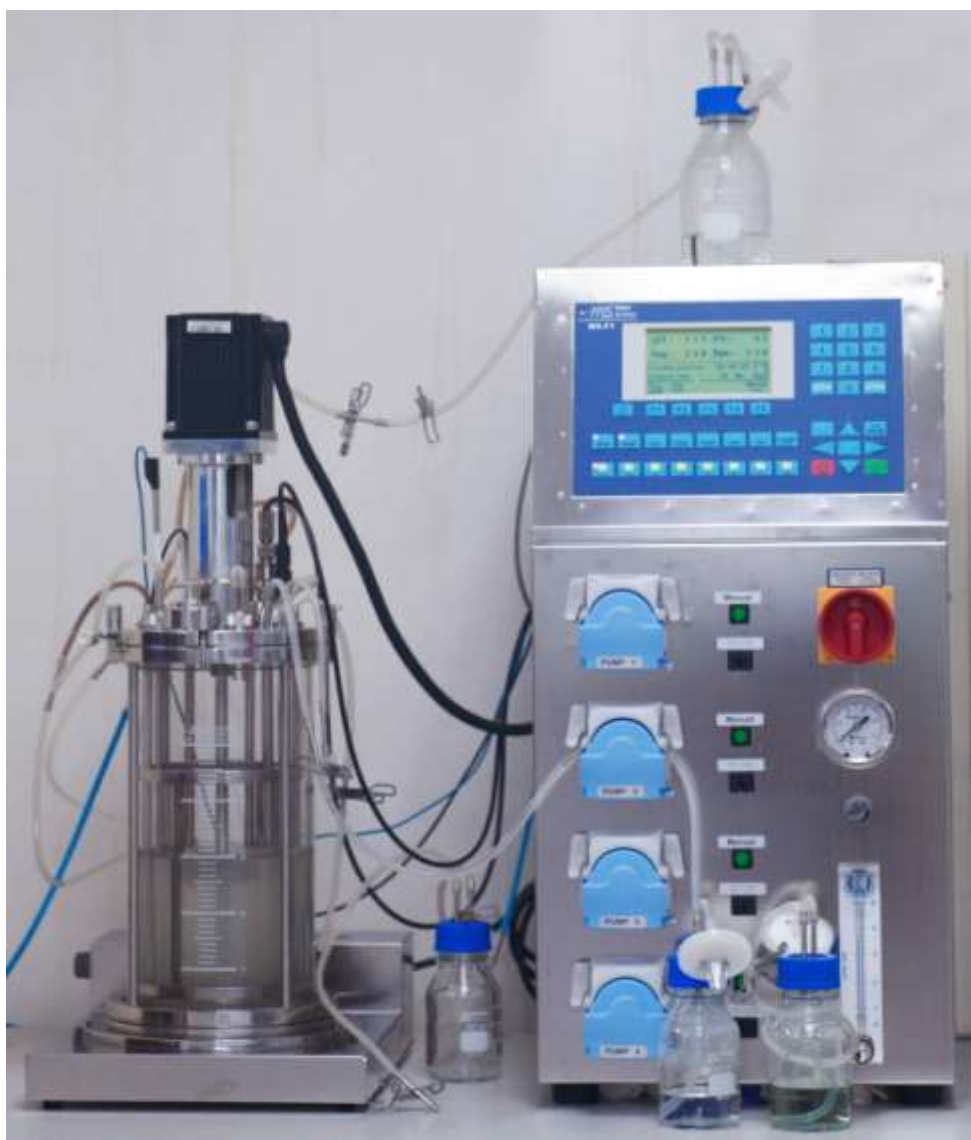
圖 4.2 生物反應槽實驗裝置
