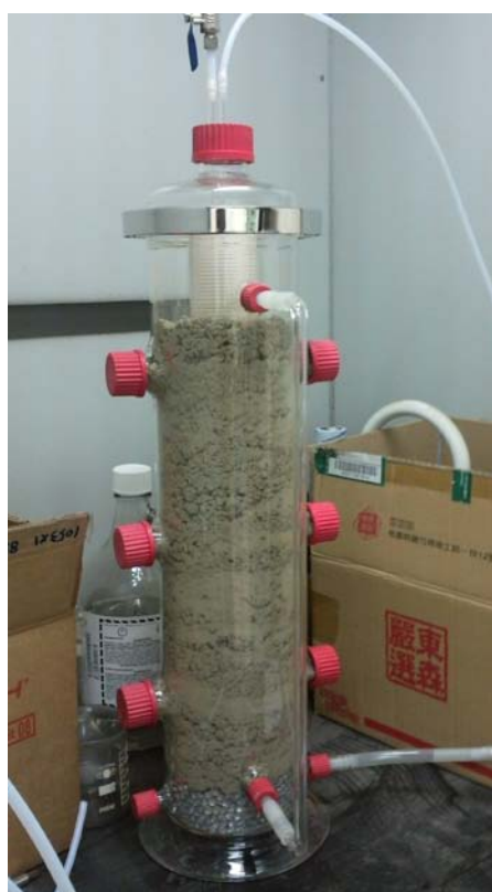
圖9 實驗管柱 (左) 管柱土壤填充 (右)管柱土壤及地下水填充
