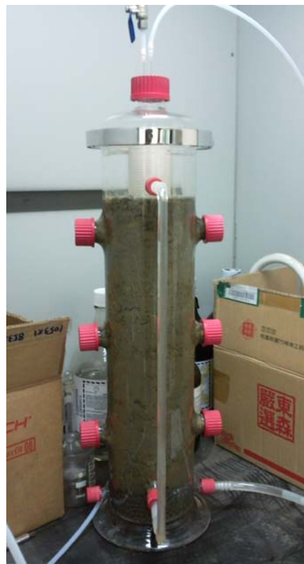
圖9 實驗管柱 (左) 管柱土壤填充 (右)管柱土壤及地下水填充
