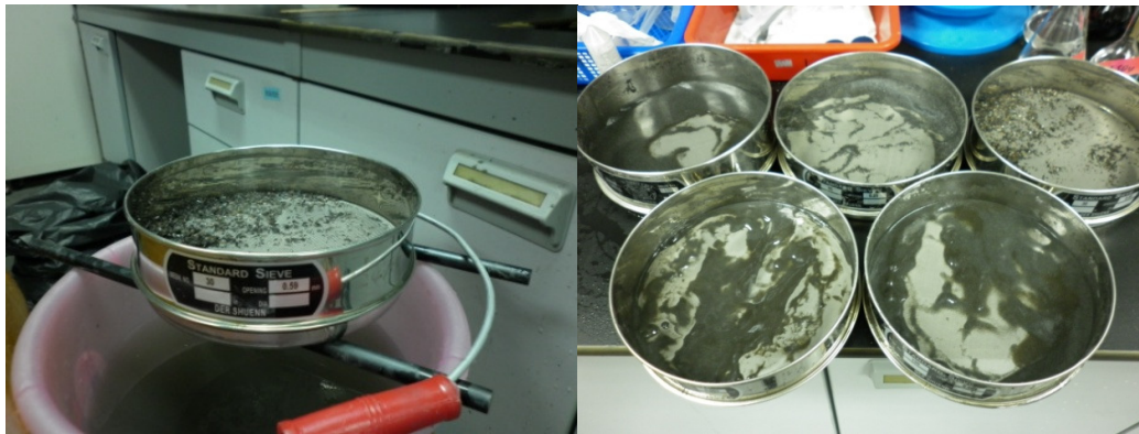
圖 4-2 篩分實驗運作情形 (土壤篩網：#10, #30, #60, #150, #270)
