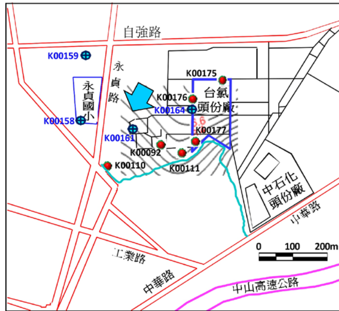
圖九 頭份工業區監測井位置。紅色圓點表示的井是淺層監測井，深度小於 20 米。藍色圓圈表示的的井是深層監測井，深度大於 50 米。
