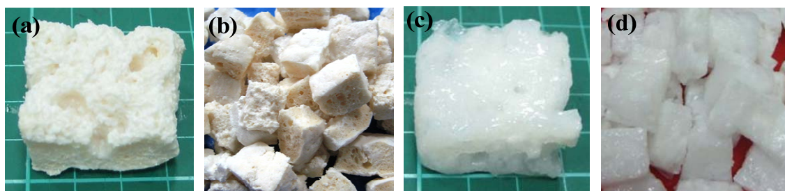
(a)、(b)：以過氧化鈣( \text{CaO}_2 )製作之 ORCB；(c)、(d)：以過氧化鎂( \text{CaO}_2 )製作之 ORCB
