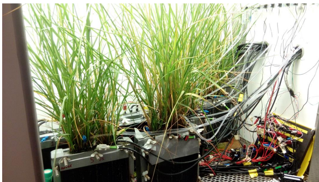
圖 16 植物微生物燃料電池實驗裝置圖
