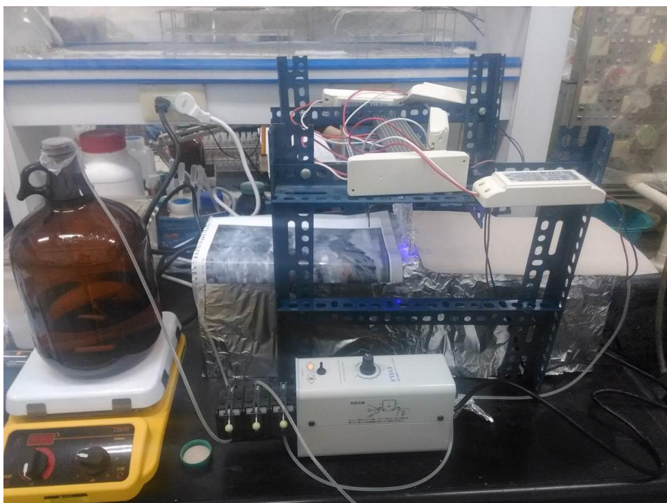
圖 9、COFB 之透水性反應牆系統設置圖
