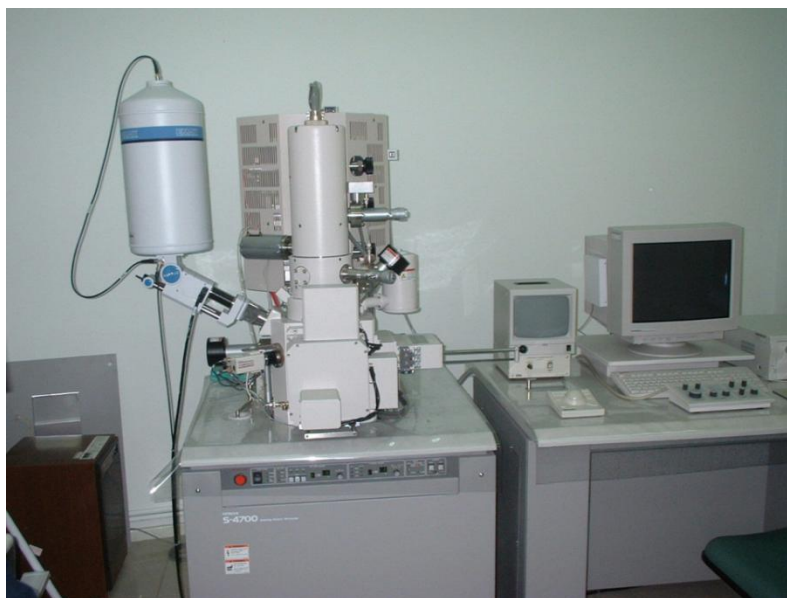
圖 4.17 FE-SEM 儀器裝置
