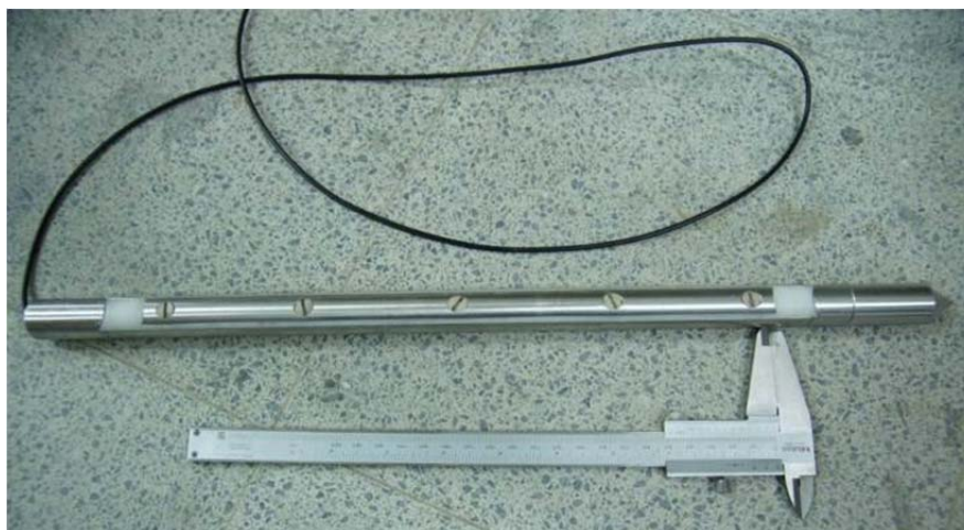
圖 27 TDR 串接貫入感測器 (楊士輝,2011)
