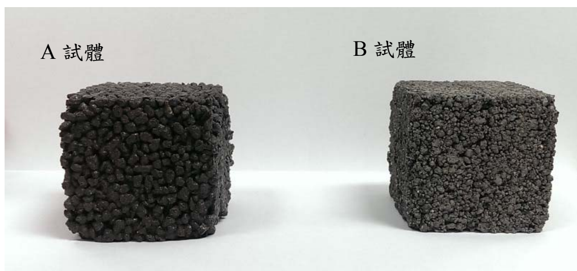
圖 5-31 透水性混凝土反應材 (a) 4-8 mesh A 型複合材；(b) 25%4-8 mesh、40%8-16 mesh、35%小於 16 mesh A 型複合材
