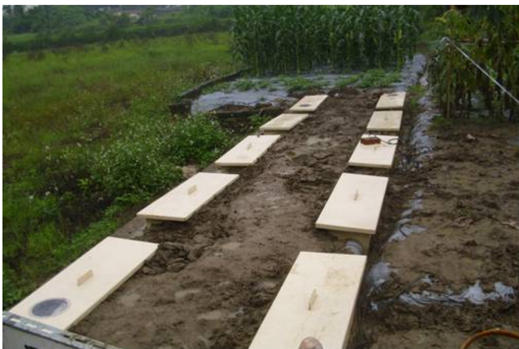
圖 3.2 電動力法(CEEK) 現地整治鉛重金屬污染場址圖
