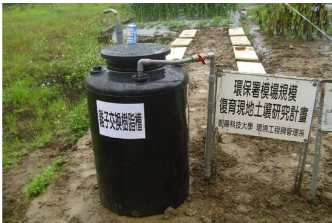
圖 3.4 電動力法(CEEK) 整合離子交換樹脂法整治圖
