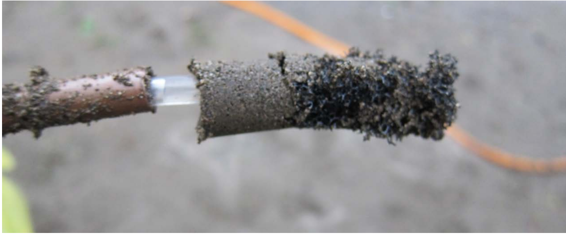
圖 3- 23 觀察抽取杯淤積砂土的情形。
