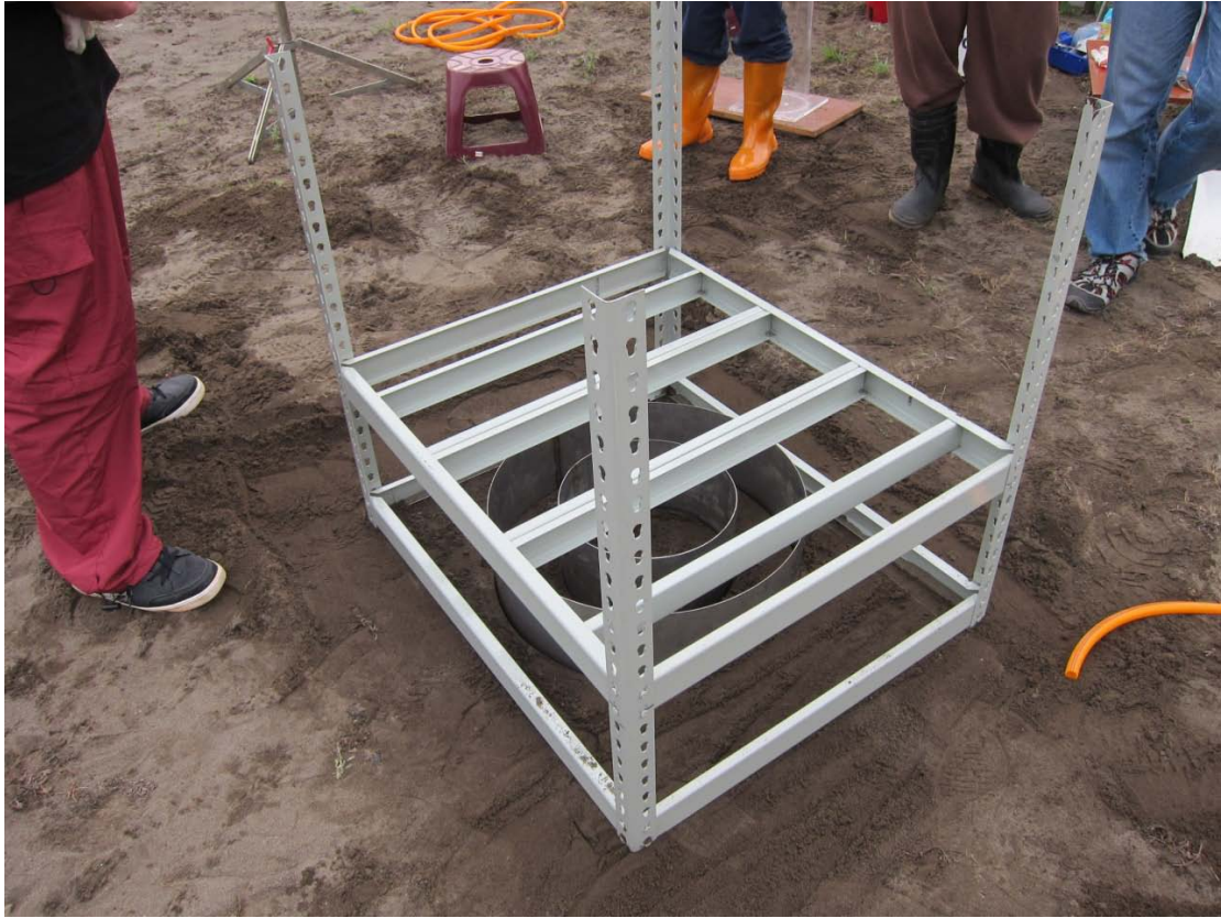
圖 3- 16 定水頭裝置的支撐鐵架(改良後)。
