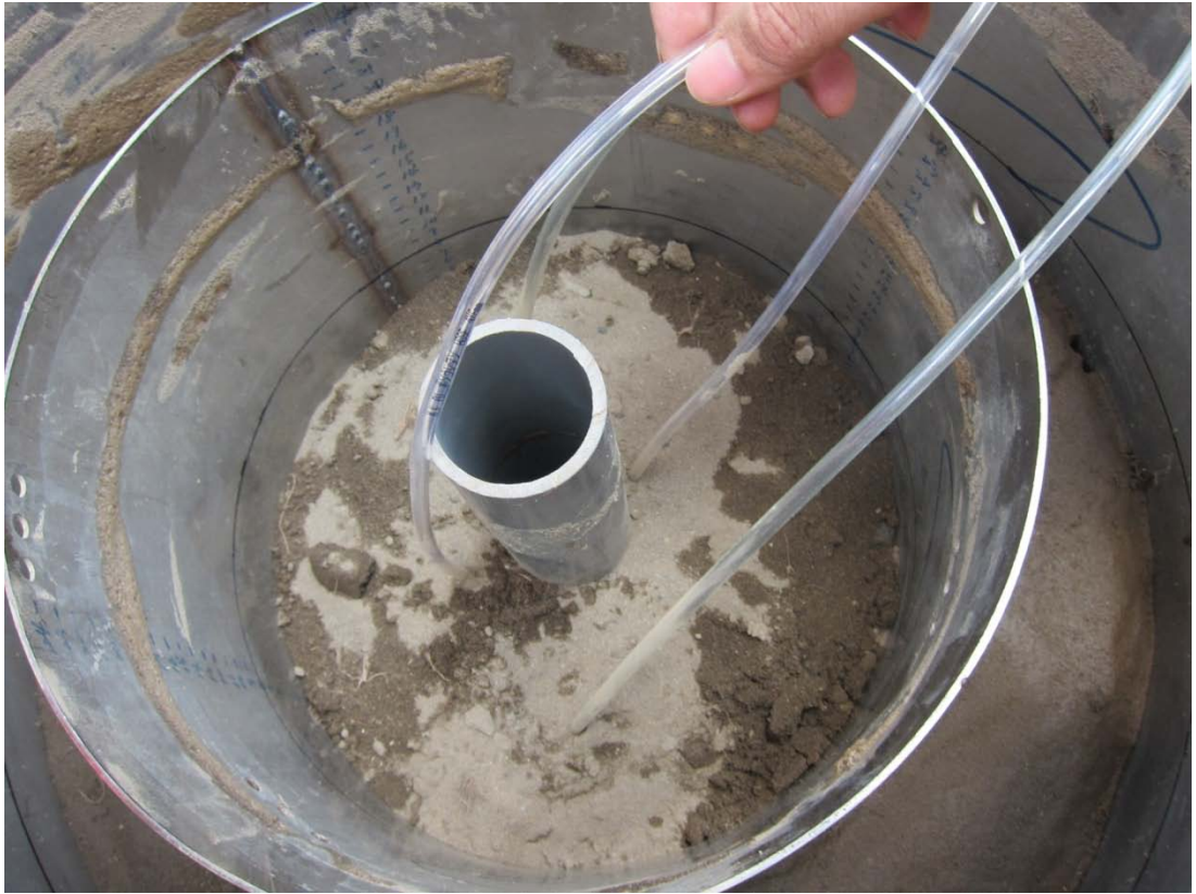
圖 3- 24 拔起抽取杯套管後回填砂土之情形。
