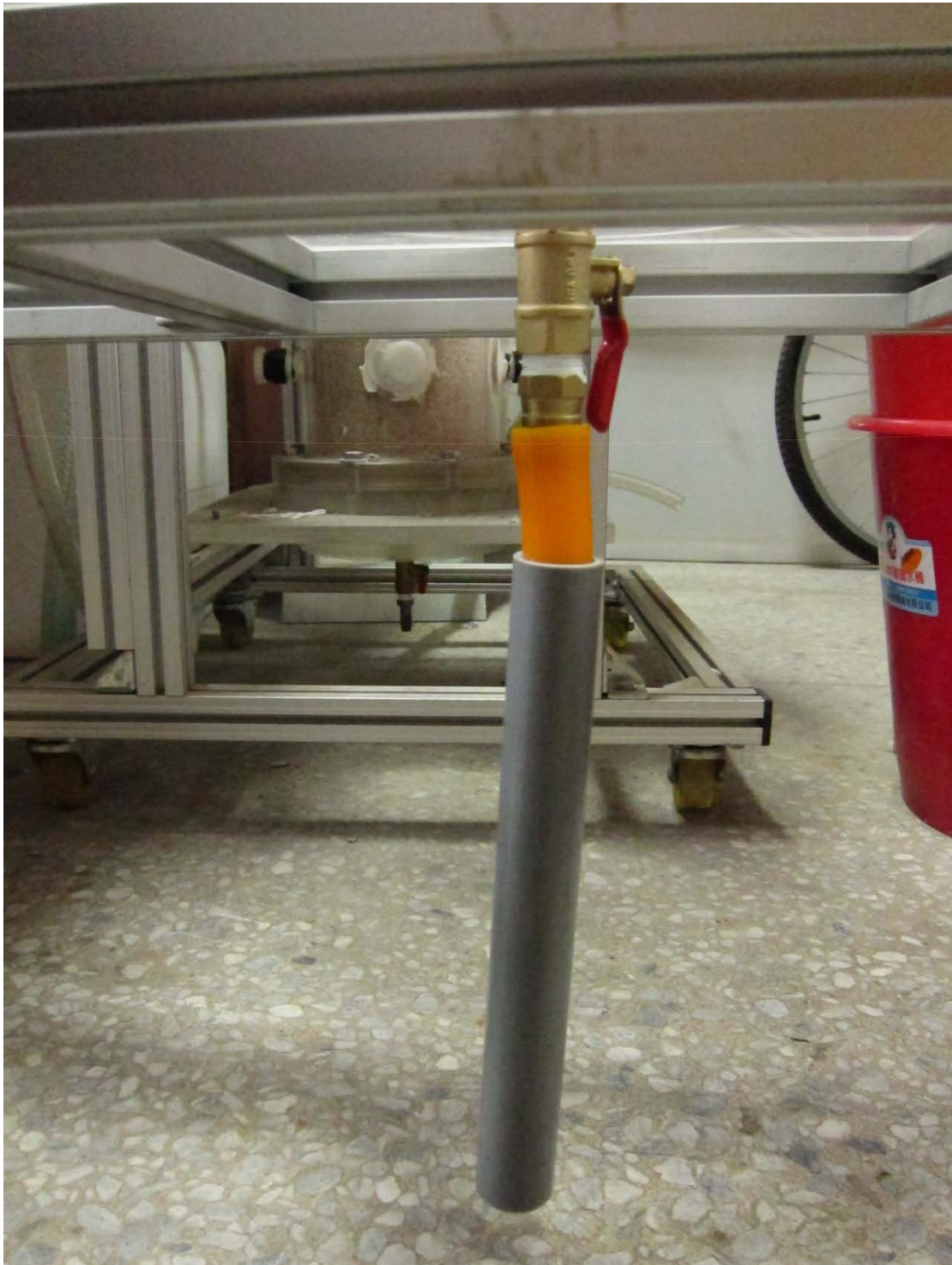
圖 3- 20 塑膠軟管外套上硬管之改良圖。
