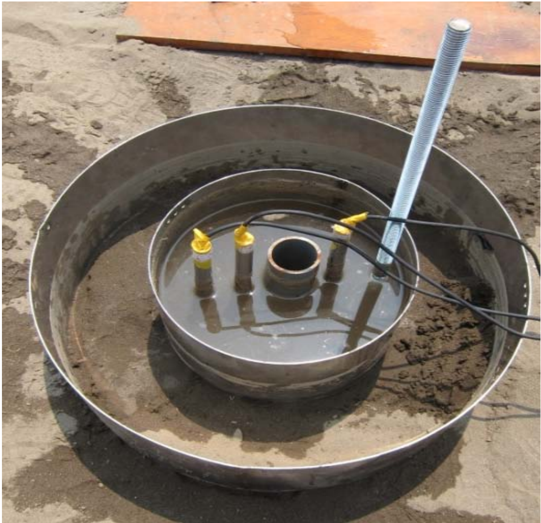
圖 3- 6 鑽孔放置抽取杯。
