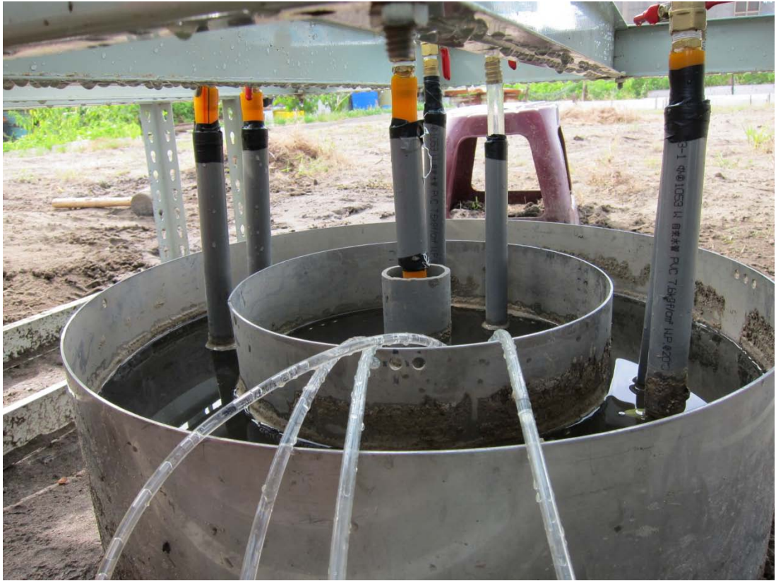
圖 3- 25 改進出水口位置與硬管套管後情形。
