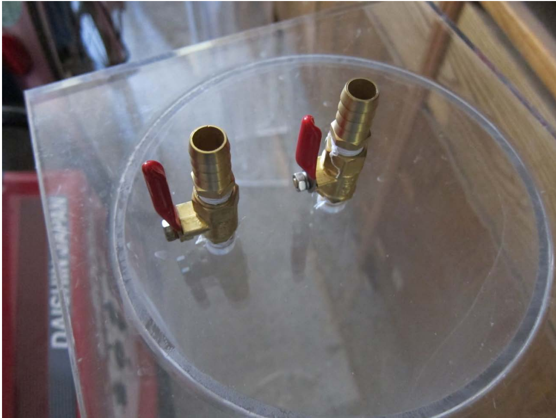
圖 3- 15 定水頭裝置底盤閥門數增加至兩個(改良後)。
