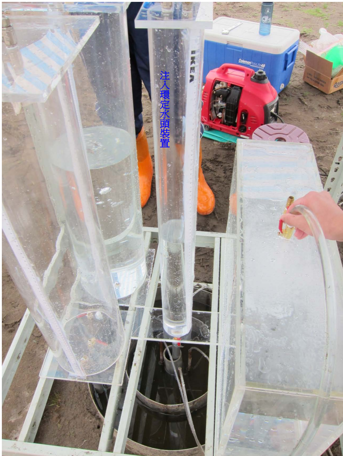
圖 3- 18 改良後的注入環定水頭裝置。
