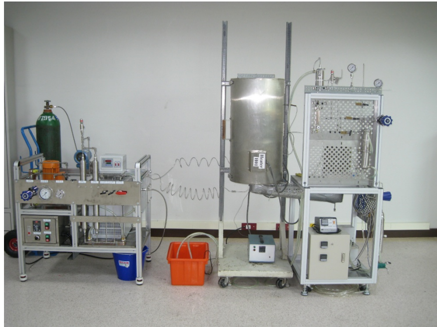
圖 3.6 超臨界二氧化碳萃取實驗設備
