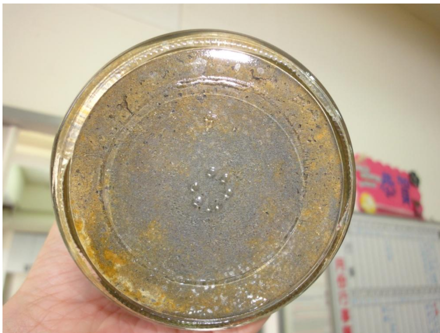
圖 11. 0.5 M SPS/2.0 M \text{Fe}^0 之反應系統。於反應一天後觀察發現其 \text{Fe}^0 沉澱於反應瓶底部。
