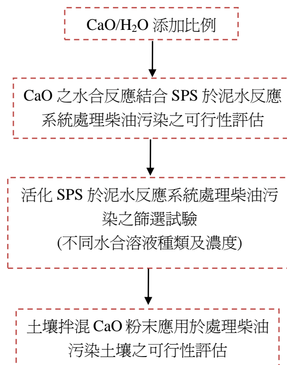
圖 4. 石灰水合反應活化過硫酸鹽處理柴油污染實驗流程
