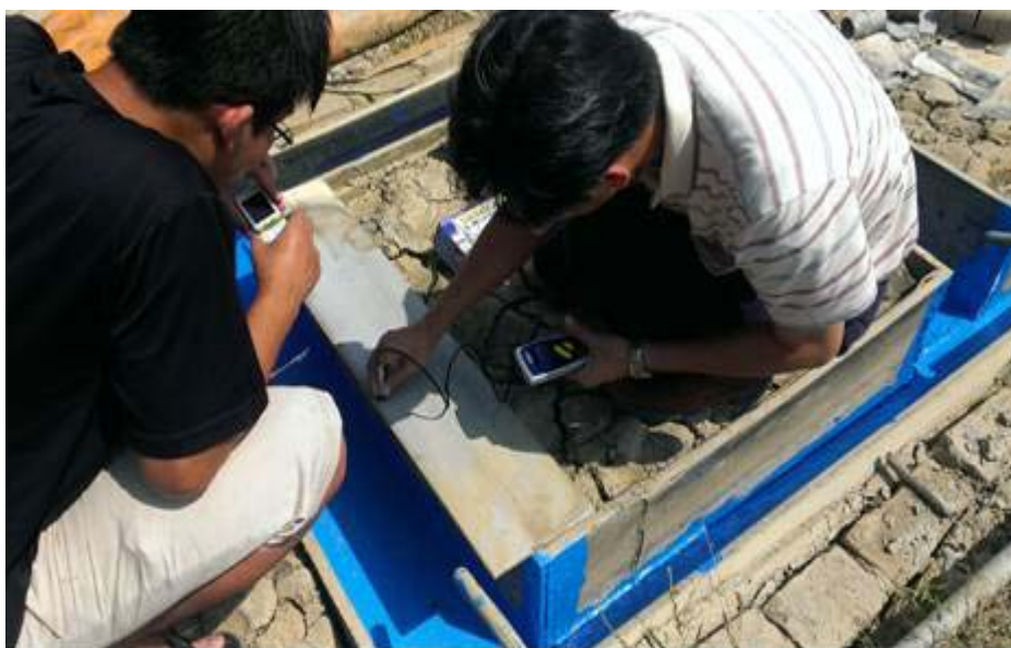
圖 3.6 渦電流膜厚計量測陰極板電鍍鉛的情形
