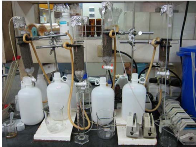
圖 2.3 動態管柱實驗配置圖
