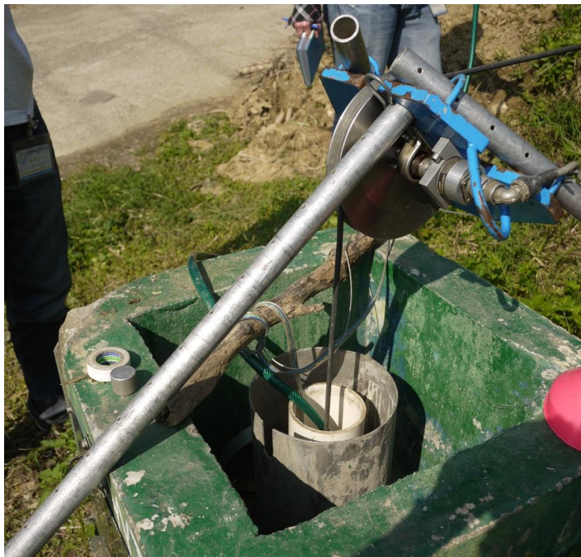
圖 3.10 熱脈衝流速儀現地試驗之儀器配置
