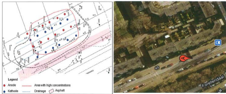
圖 11、荷蘭海牙住宅區整治場址電動力裝置設立圖
