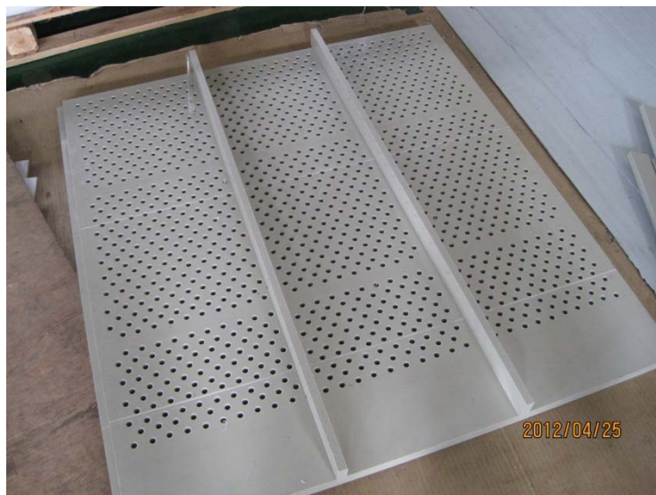
圖 36、內部檔板照片 (1.0 m × 1.1 m，L × H)
