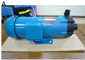
圖 37、A:操作流質補充泵浦(型號 CPT65)； 圖 38、桌上型三用電表(型號 UT804) B:土壤溫度計
