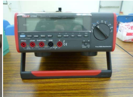
圖 37、A:操作流質補充泵浦(型號 CPT65)； 圖 38、桌上型三用電表(型號 UT804) B:土壤溫度計
