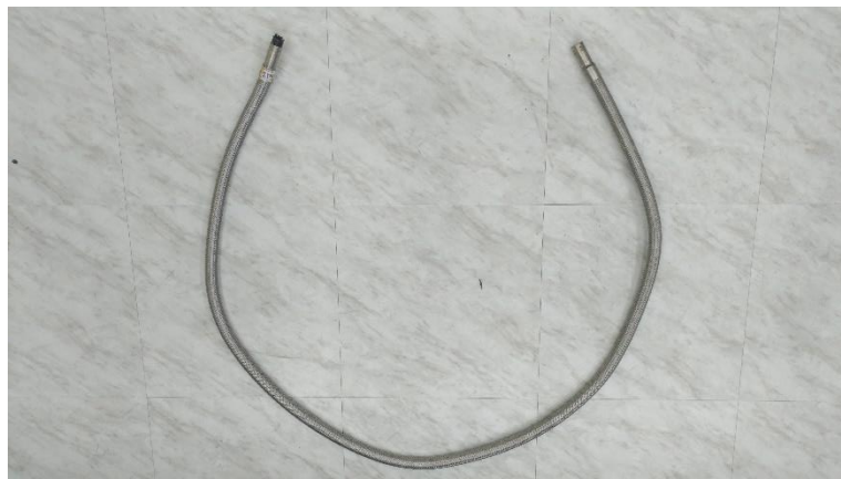
圖 30 FBG 水溫與水壓計實體圖
