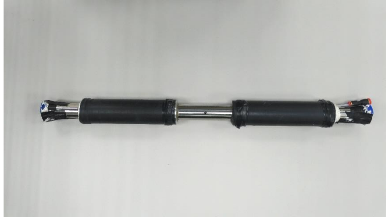
圖 30 FBG 水溫與水壓計實體圖
