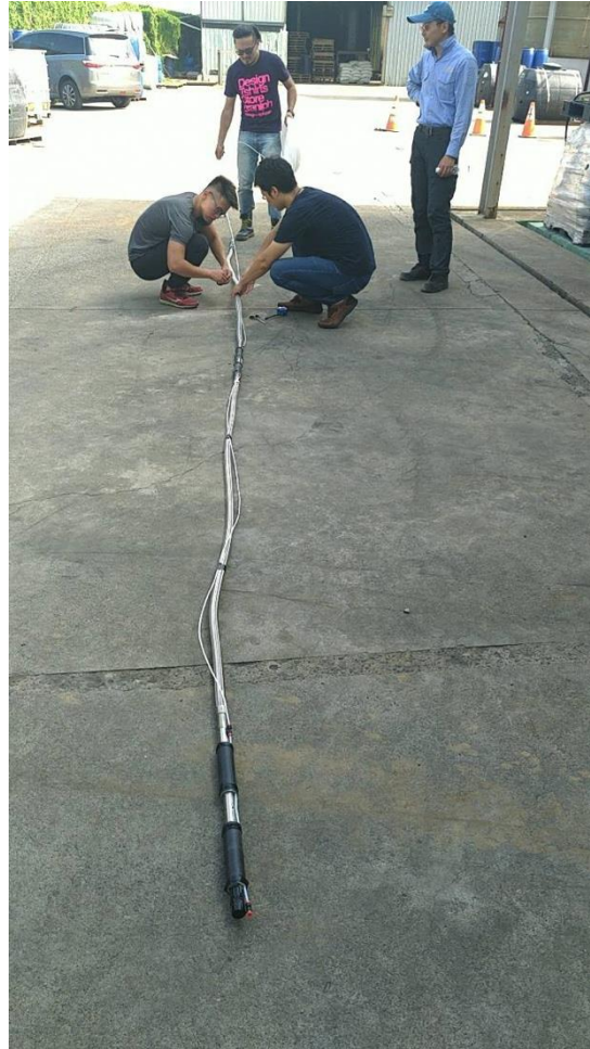
圖 32 現場組裝 FBG 水溫與水壓計以及延長段
