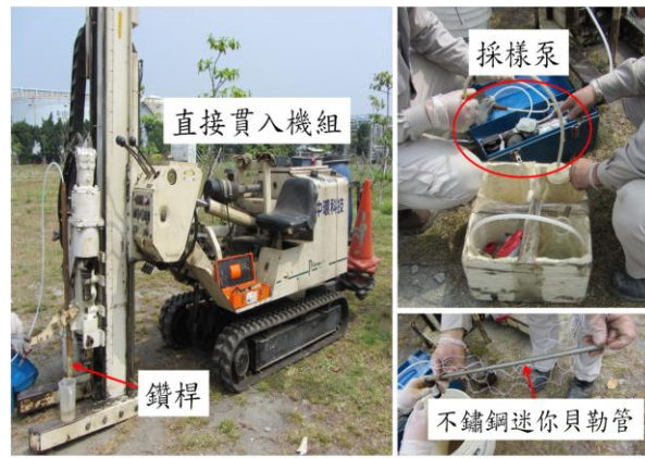
圖 3、直接貫入法使用的儀器及設備
