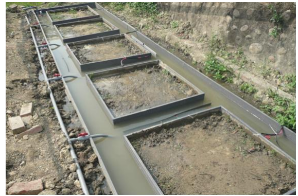
圖 2 CEEK 整治鉛污染農地現場系統圖
