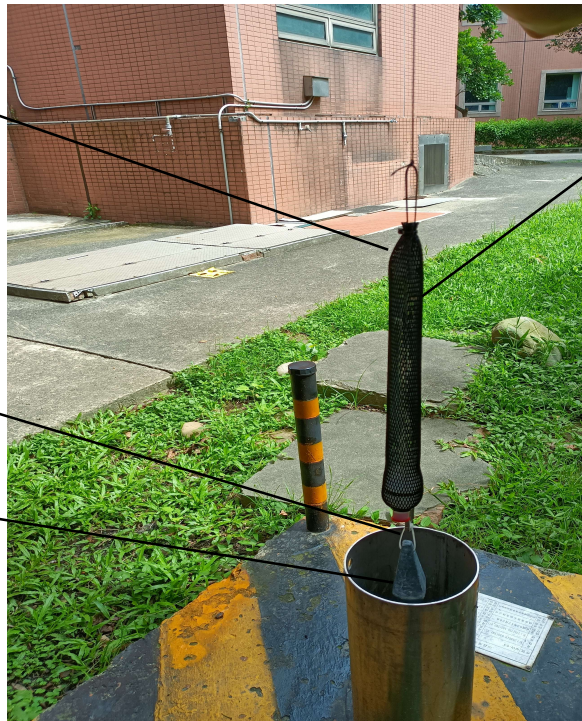
圖二 監測井地下水揮發性有機物被動式擴散採樣袋採樣
